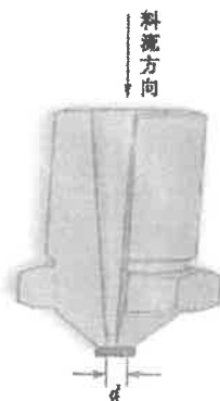
图 6 挤出头示意图
