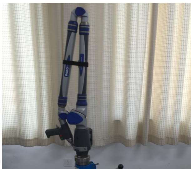
图 4 FARO Arm 柔性激光扫描测量仪
