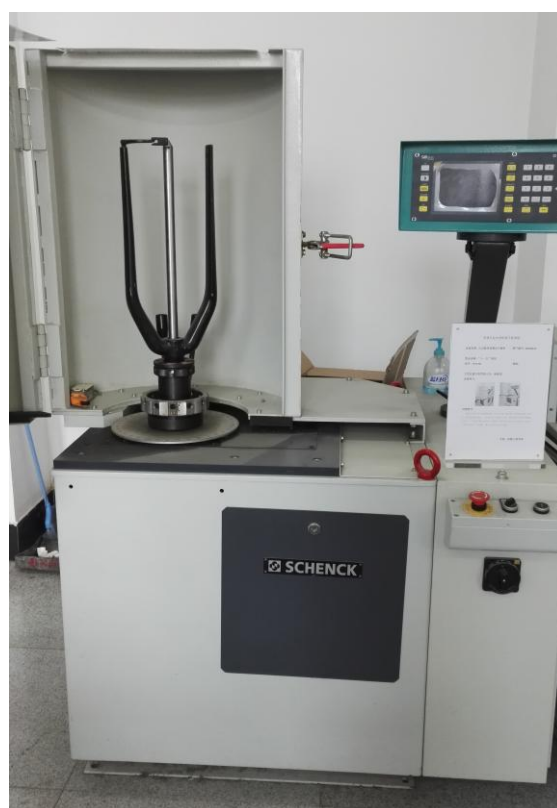
图13 粗纱锭翼动平衡试验台
