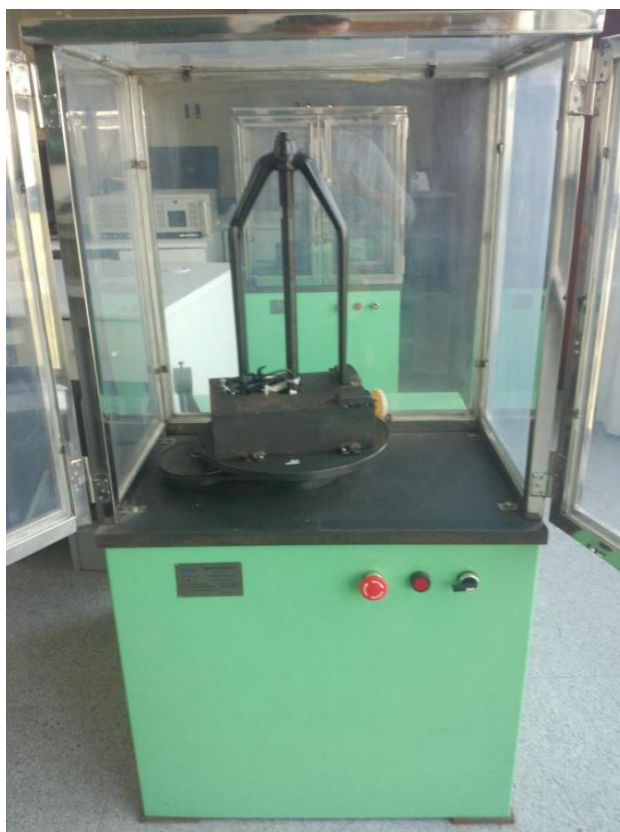
图14粗纱锭翼性能测试试验台
